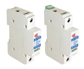
Su concepción modular facilita el montaje conjunta de diversas unidades de DPS, conectados directamente o no a los barramientos, así como a otros componentes de los tableros de distribución de circuitos. Puede actuar diversas veces sin necesidad de ser reemplazado o reencendido. La fijación del DCL es sencilla y rápida, hecha sobre carriles estandarizados de 35mm, estándar europeo (DIN) o a través de garras, estándar americano (NEMA).
